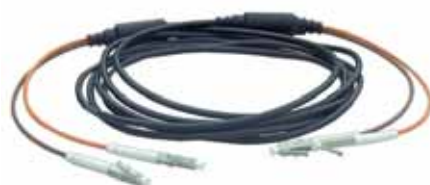
Gepanzerte Glasfaser-Anschluss-Kabel: Eine Edelstahlwendel und ein galvanisiertes Stahlgeflecht machen die innenliegenden Fasern beinahe unzerstörbar.
