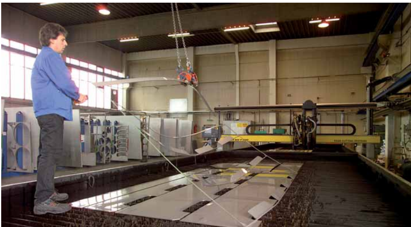
Fertigung eines Plasmazuschnittes (Foto: Bogner Edelstahl)
